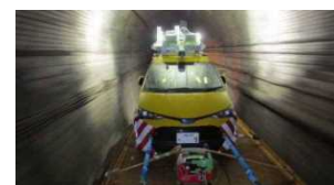
鉄道トンネルにおける道路用3次元点群データ計測車両の活用(高度化・効率化の事例)
