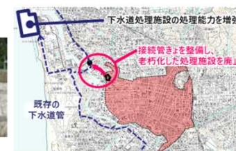
流域の処理場の能力を増強し、2つの処理場の機能を統合(再編の事例)
