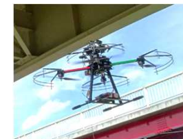
橋梁の損傷写真を撮影する技術(効率化の事例)
