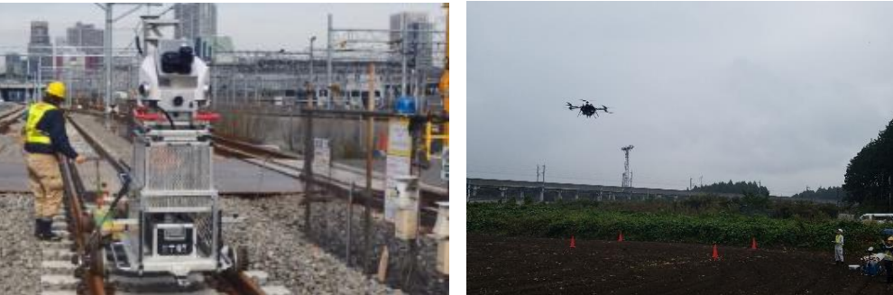
3D測量の実施(左:MMS型、右:UAV)
