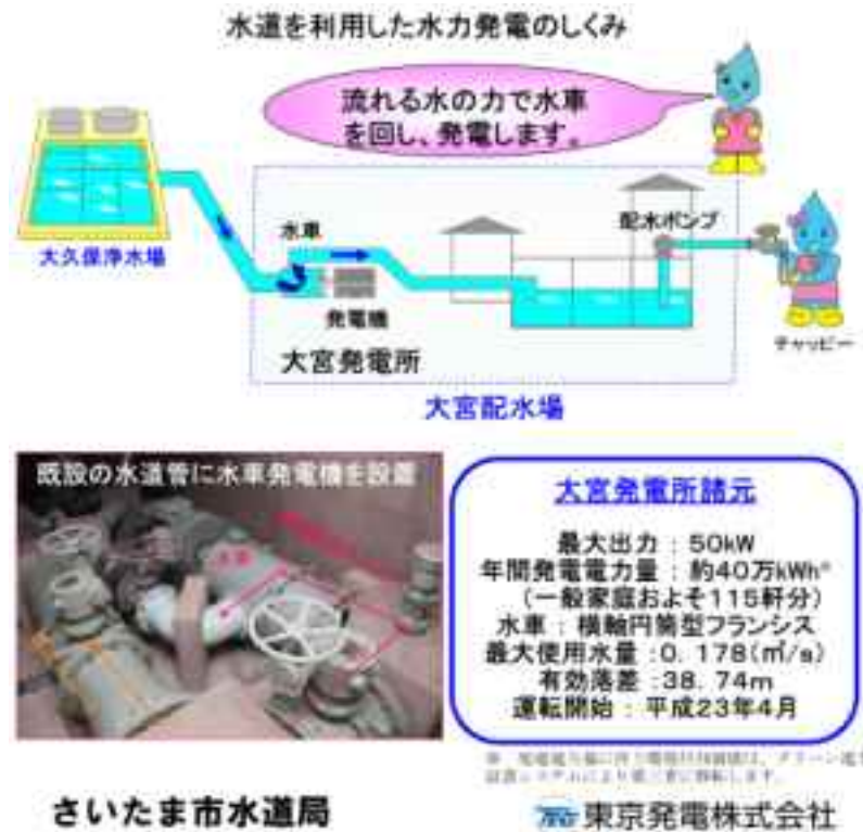
図 56 上水道・工業用水道における水力発電の状況（埼玉県の事例）
