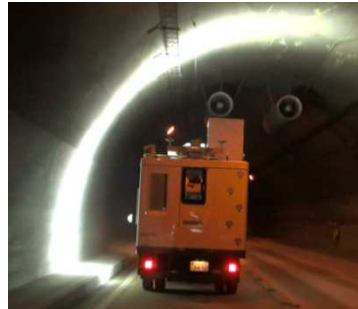
← トンネルの変状写真を撮影する技術 【4技術】
