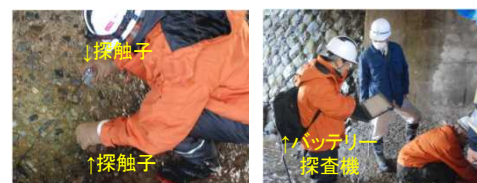
(例) 超音波探査で空洞を測定
