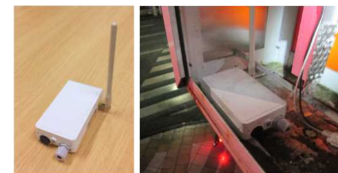
(例) 加速度データで落下・倒壊を防止
