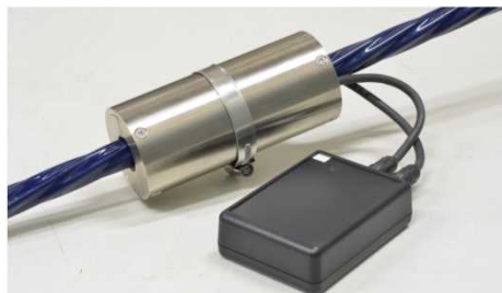
(例) 永久磁石を用いて張力を計測
