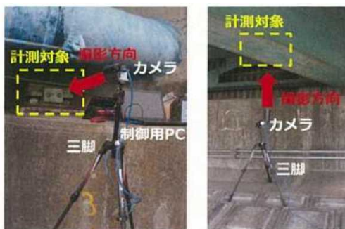
(例) 動画像を解析し変位・回転量を計測
