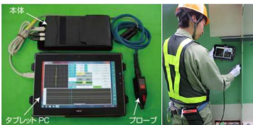
(例) 渦電流探傷法でき裂を判定
