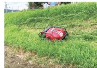
リモコン式草刈機による作業
