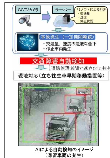
交通障害自動検知システム
