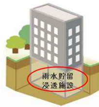
雨水貯留浸透施設
