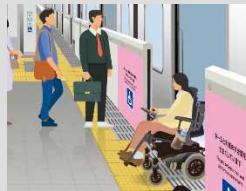
段差・隙間の縮小
