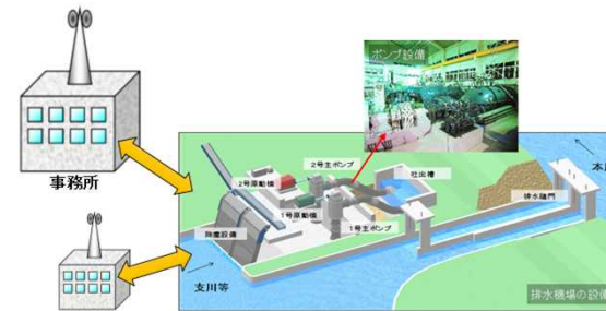
遠隔監視・操作化により、緊急時においても排水作業が可能(排水機場の遠隔化イメージ)
