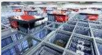
自動倉庫型ピッキングシステム
