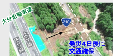
【大分自動車道 九重IC～湯布院IC】 九重IC～湯布院IC間の上り線で路肩崩壊が発生し、並行する国道210号も同時に被災。一時交通が寸断されたものの、大分自動車道の下り線を対面通行として活用することで、発災4日後に広域交通を確保
