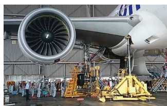
航空機整備作業の例(主脚の交換、電子装備品の交換・調整)
