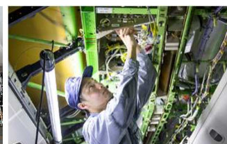
航空機整備作業の例(主脚の交換、電子装備品の交換・調整)
