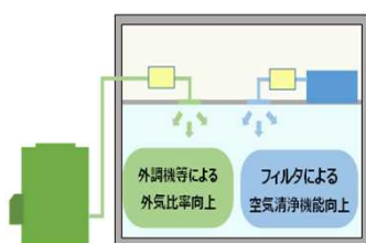
空調・換気設備の機能向上
