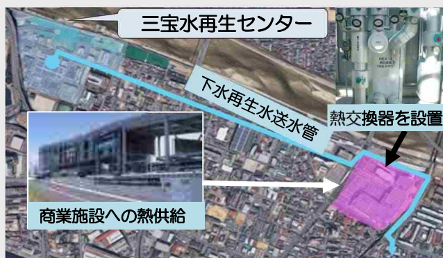
大型商業施設への熱供給（大阪府堺市）
