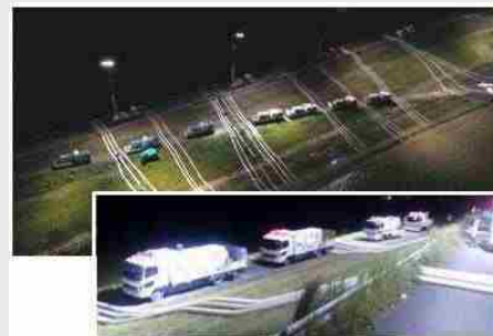
排水ポンプ車による 24 時間体制の緊急排水状況【宮城県大崎市 (吉田川)】
