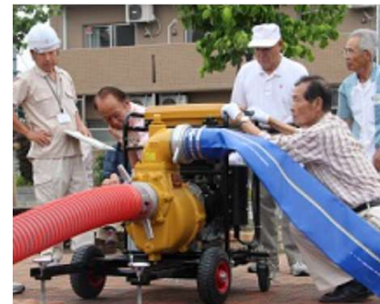
水防用排水ポンプ
