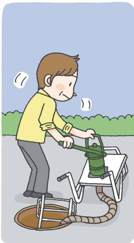
マンホールトイレによっては、使用後にポンプで水を流すなどが必要です。
