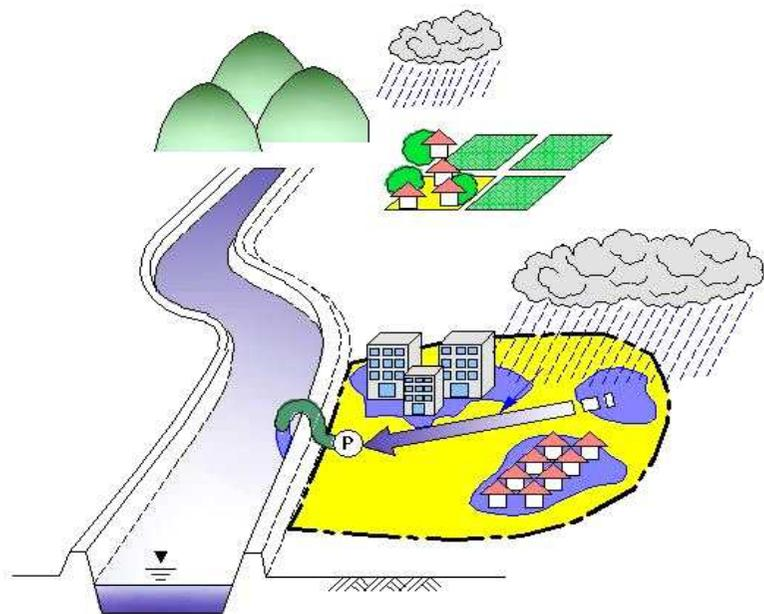
下水道の雨水排水能力を上回り浸水、または河川水位の上昇により、下水道から河川へ放流できず浸水
