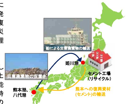
災害廃棄物の広域輸送による処理の事例(H28年熊本地震)
