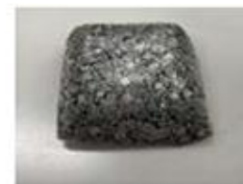
発電所での発生灰を利用した藻礁
