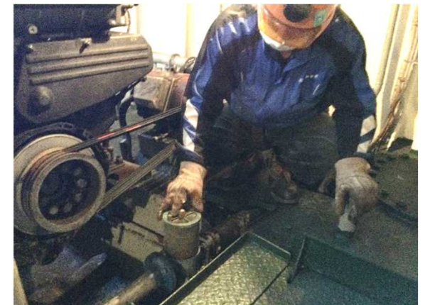
被曳航中の海水フィルター 清掃作業手順等確認状況
