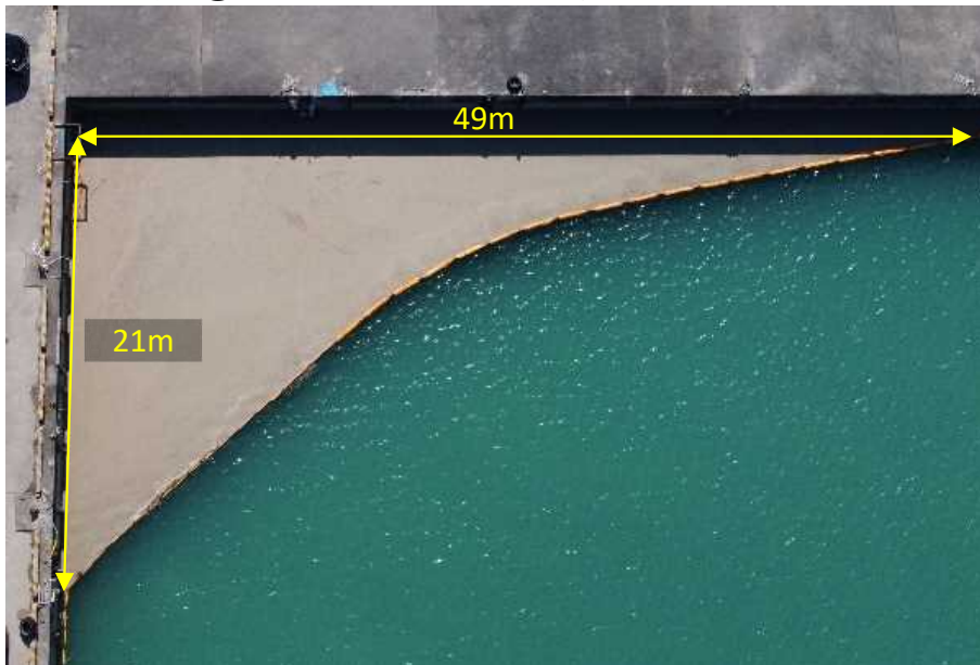
参考写真①: オイルフェンスの展張状況
