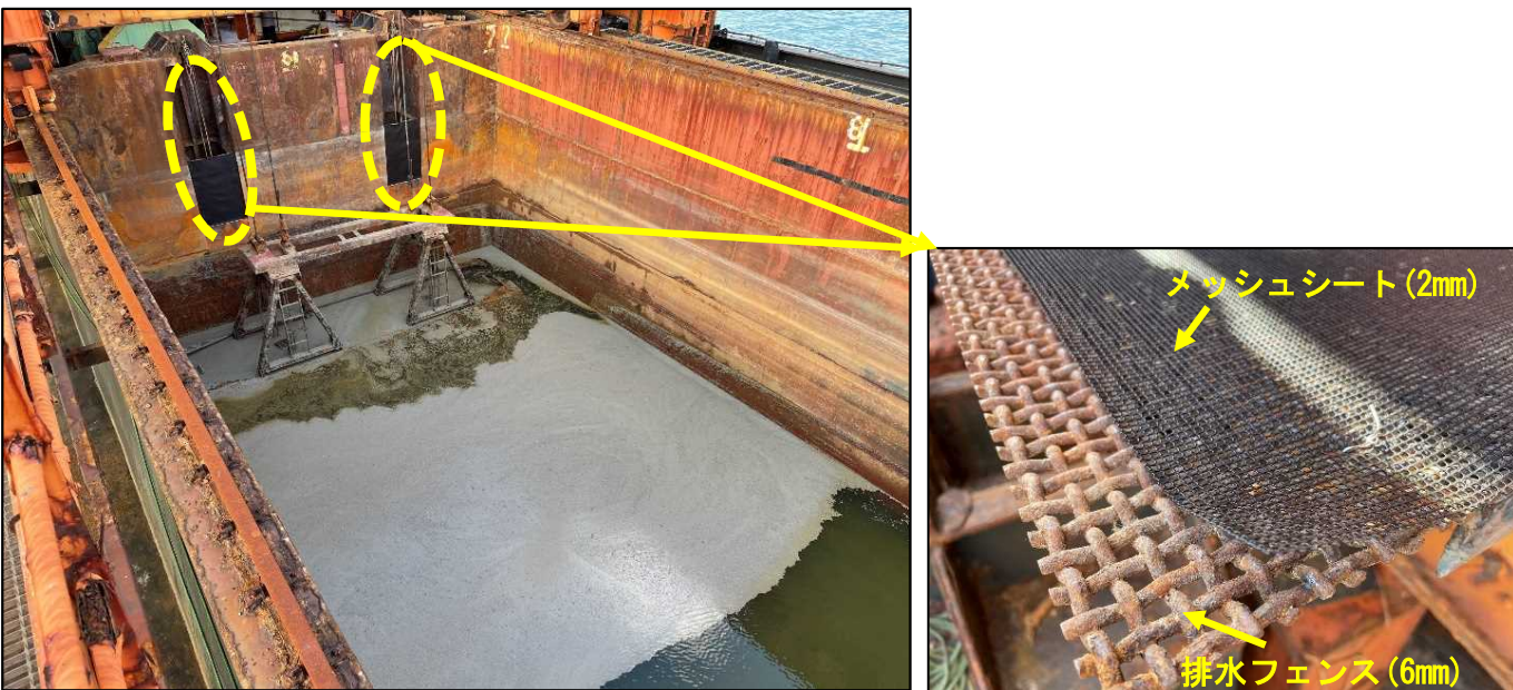
参考写真②：ホールド内の軽石及び海水、排水フェンス
