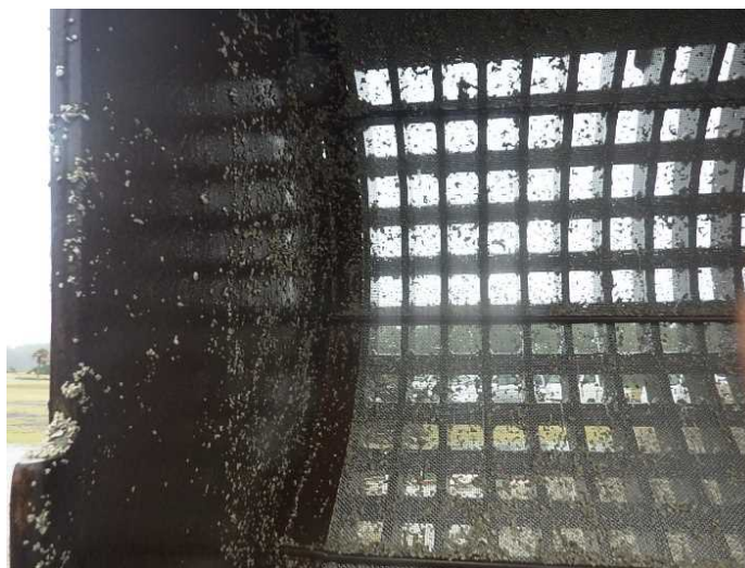
参考写真①: スケルトンバケット(2mmメッシュ装着)
