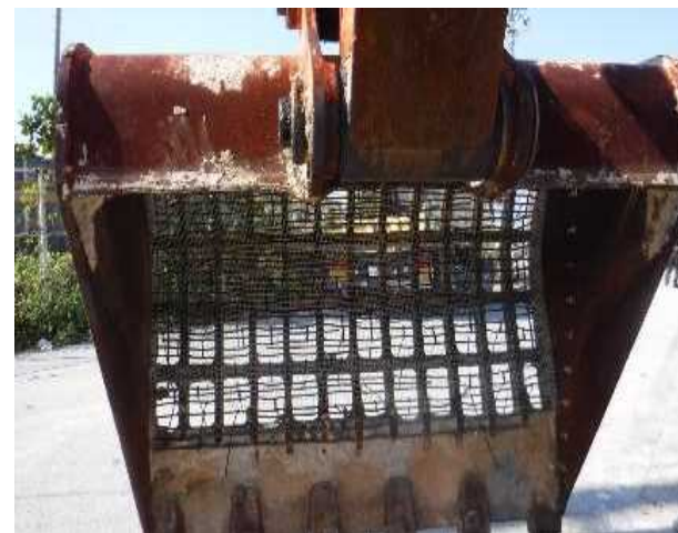
参考写真③: スケルトンバケット(メッシュ装着)
