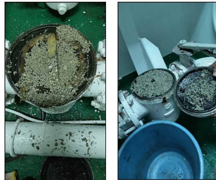
参考写真④：ストレーナーへの軽石付着状況
