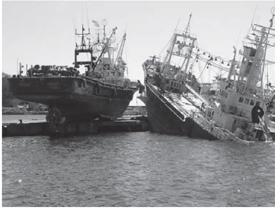
小名浜漁港の岸壁に乗揚げたまき網漁船 (津波浸水高 約4m)
