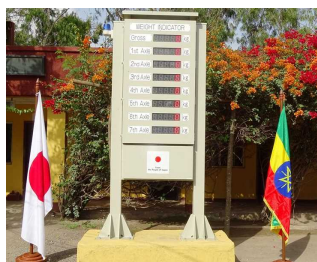
(写真) 軸重の計測読み取り
