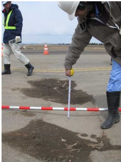
写真－2. 1 【基礎地盤の液状化による局所沈下】の測定例 (左は沈下幅に対してポールが足りておらず、実際の凹み量はもっと大きい) (右は沈下幅に対して十分な長さのスタッフを使用している)
