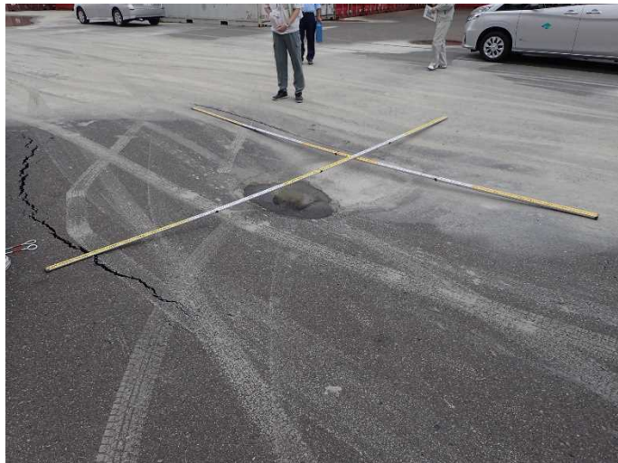
写真－2. 1 【基礎地盤の液状化による局所沈下】の測定例 (左は沈下幅に対してポールが足りておらず、実際の凹み量はもっと大きい) (右は沈下幅に対して十分な長さのスタッフを使用している)
