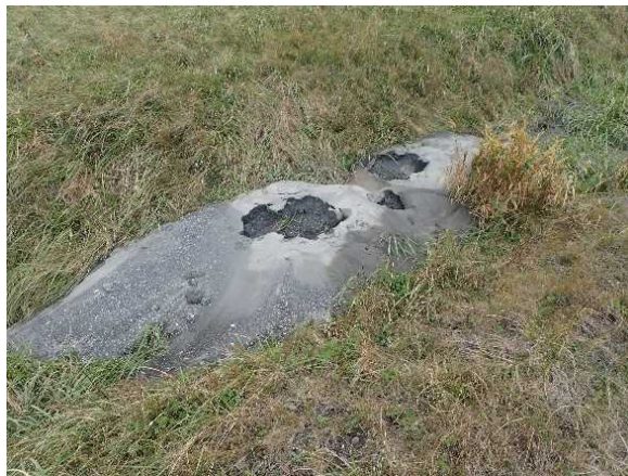
写真－2. 3 液状化による噴砂痕の例
