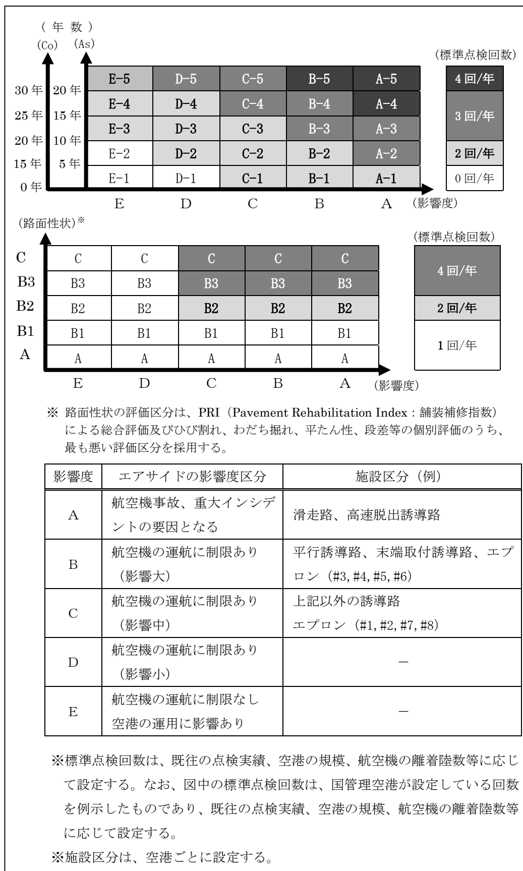
図 4.2.2 基本施設の巡回点検Ⅱの標準点検回数の設定方法 (例)
