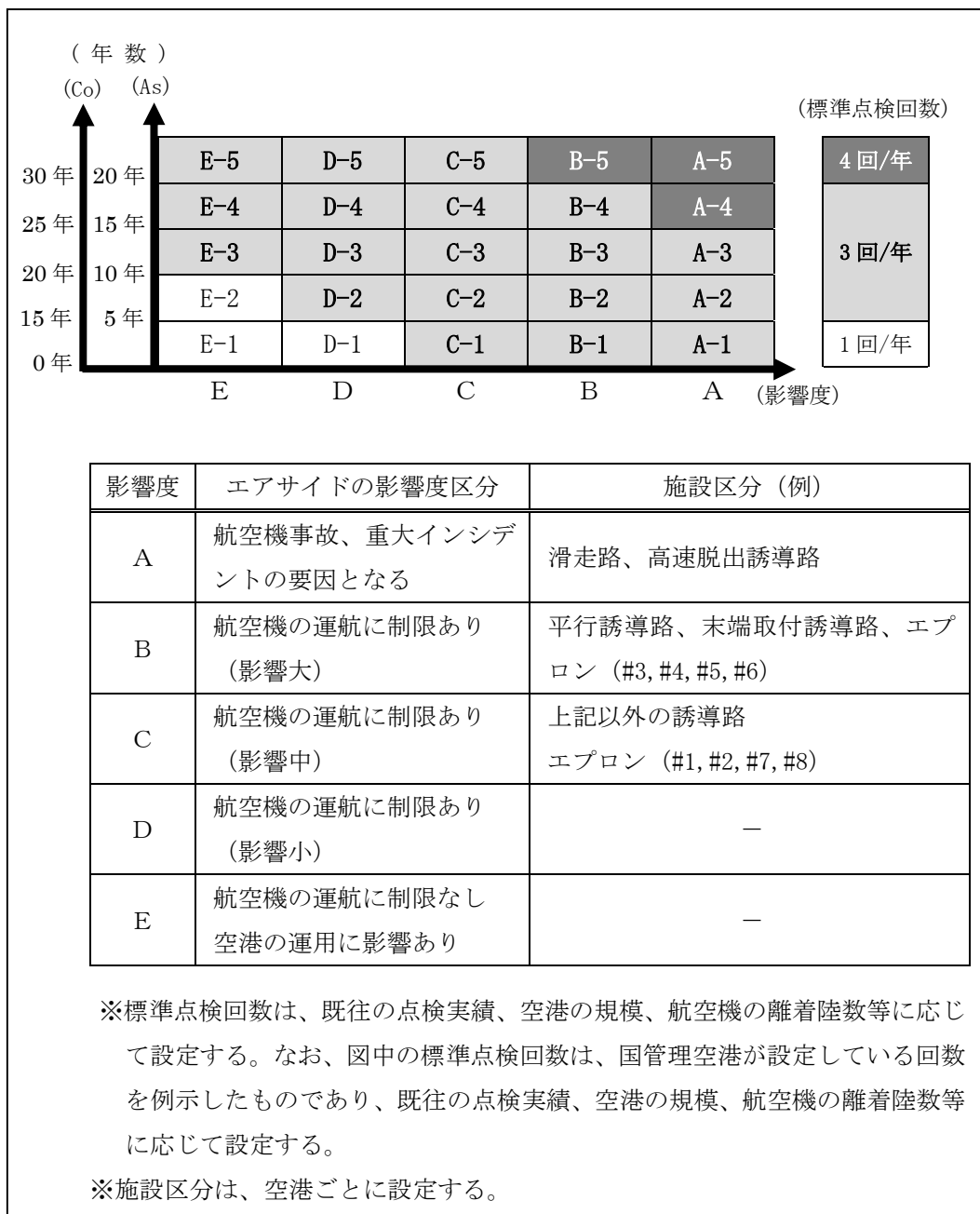
図 4.2.1 基本施設の巡回点検 I の標準点検回数の設定方法 (例)
