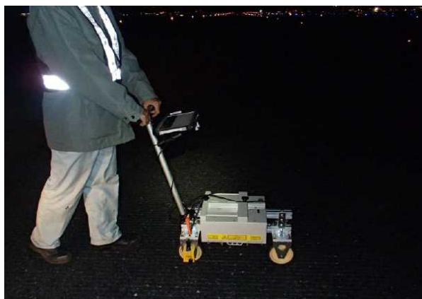
写真 4.4.3 ハンディプロファイラーによる調査状況（例）
