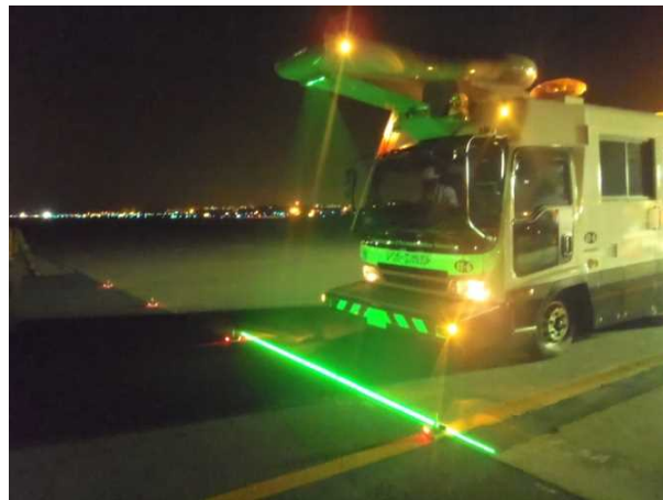
写真 4.4.2 路面性状測定車による調査状況（例）
