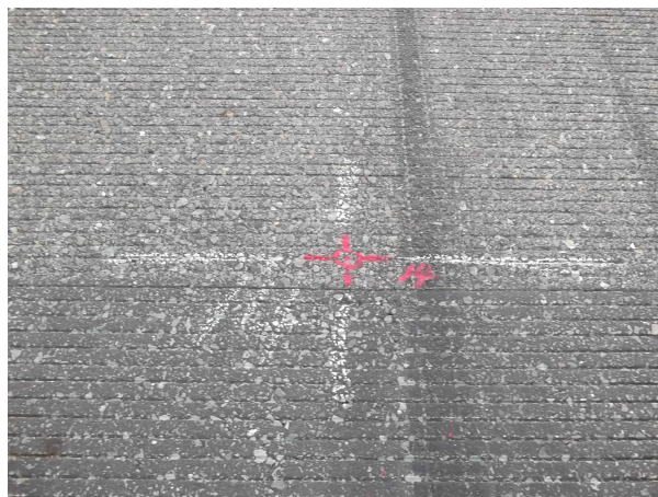
写真 4.4.4 滑走路上の測点マーキング（例）
