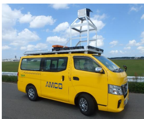
図-3-4-1 赤外線路面点検車外観
