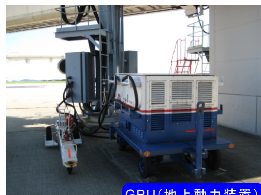
GPU(地上動力装置)
