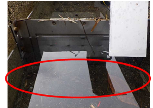
設置後 12 週間 (3/2) 時点 プレフィルタとフィルタ間に夾雑物
