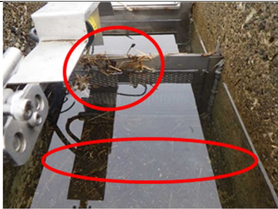
設置後 12 週間 (3/2) 時点 左：夾雑物がプレフィルタ上流で捕捉されている様子、右：本体フィルタを通水している様子
