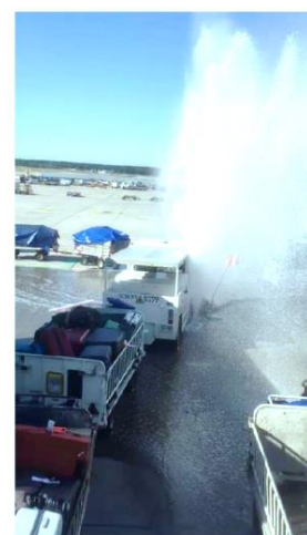
GSE車両衝突による燃料噴出事故 (図6)
