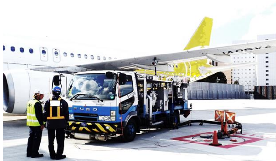
給油作業の様子
