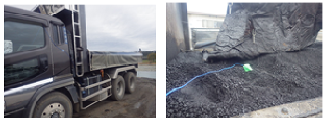
写真-2 熱電対の挿入状況
