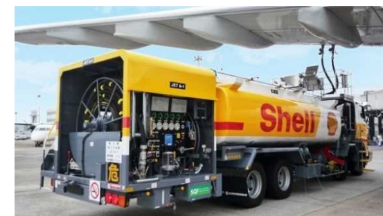
レフューラー：燃料タンクを装備し、航空機へ直接燃料を補給
