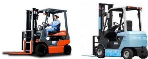
電動フォークリフト 燃料電池フォークリフト ※豊田自動織機HPより
