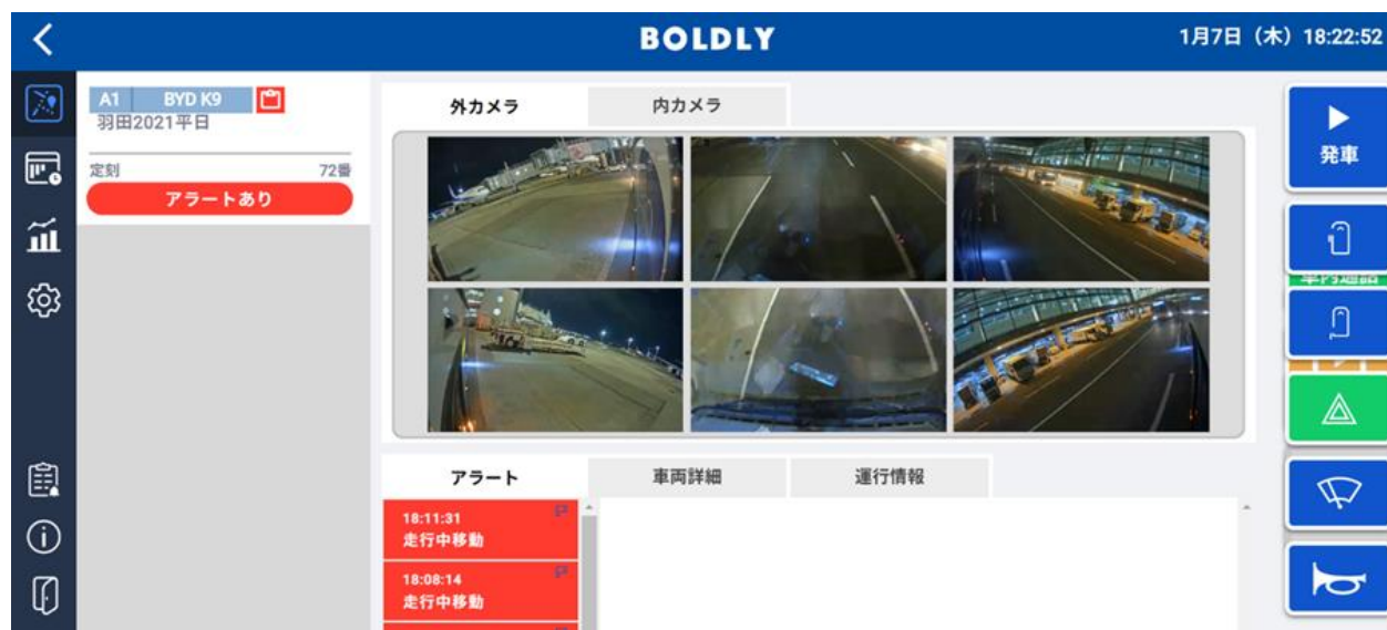
(写真4 遠隔監視システムDispatcherの画面)
