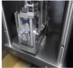
写真-2 曲げ疲労試験状況
