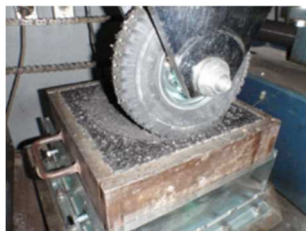
写真-3 ねじり飛散抵抗性試験
