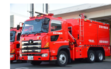
海水利用型消防水利システム(スーパーポンパー)
