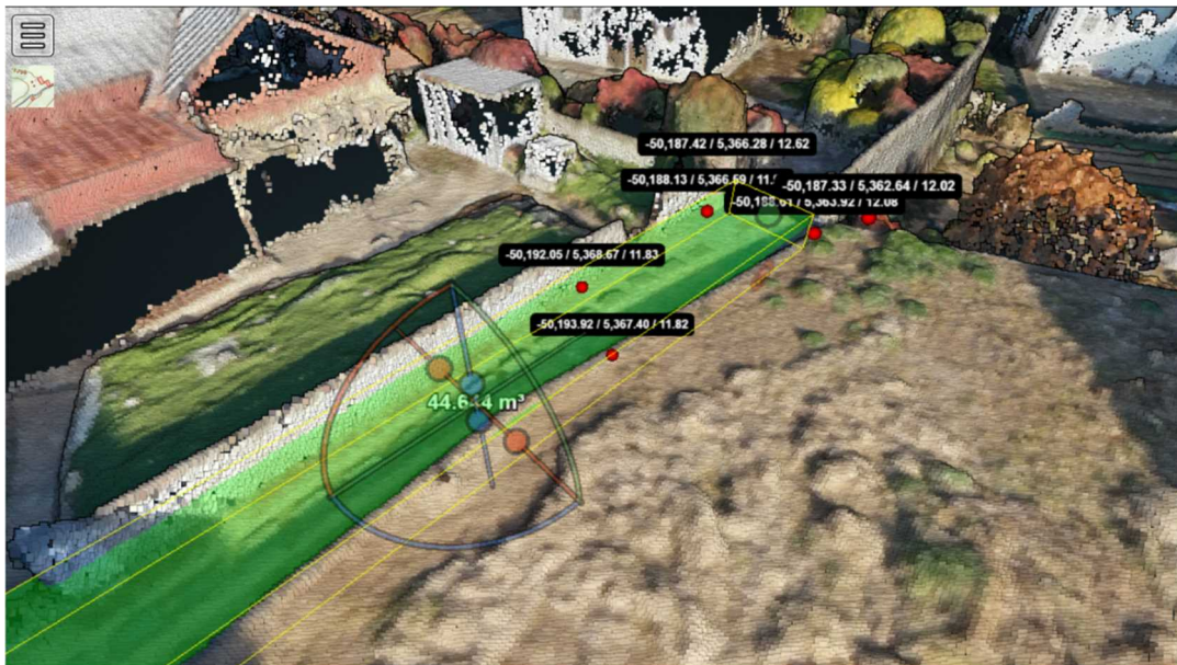
距離・面積・高低差が分かるため造成土地利用計画の策定の際の土量計算にも応用可能
