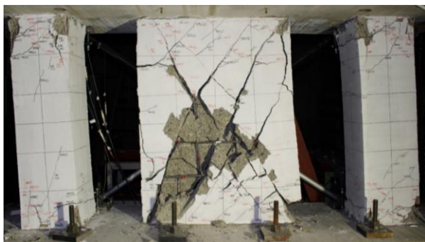
無補強試験体の破壊状況
