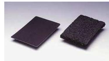
発泡材 (加熱膨張材) の例
