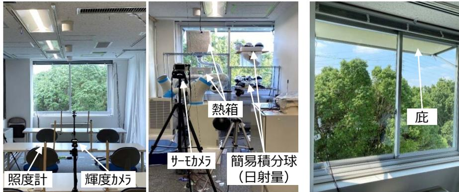
光環境測定 熱性能測定 庇設置
