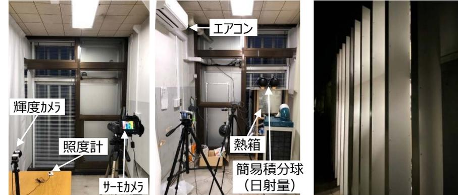
光環境測定 熱性能測定 垂直ルーバー設置
