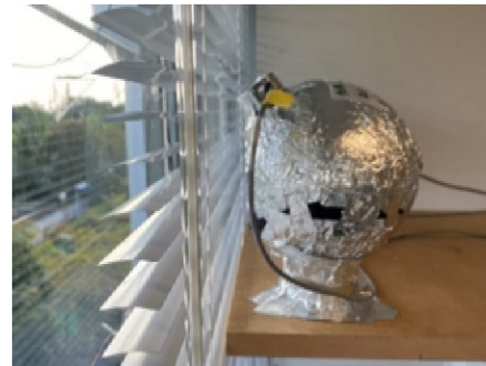
簡易積分球(左: 実物 右: 断面模式図)
