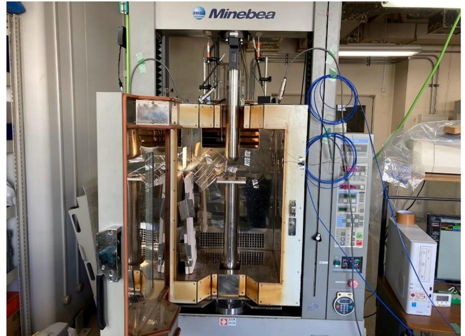
図2-4 温度調整炉付き圧縮試験機
