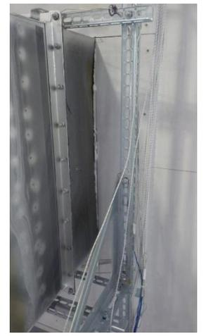
壁 防火ダンパー試験体の状況
