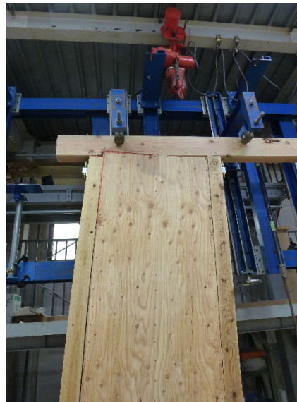
桁側の面材の踏み外し
