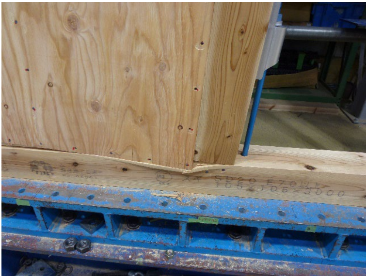
土台側の面材の踏み外し
