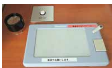
テレアンプ(受話器音量増幅器)、ノックされた場合に振動するベッドシェイカー(ライトも点滅)
