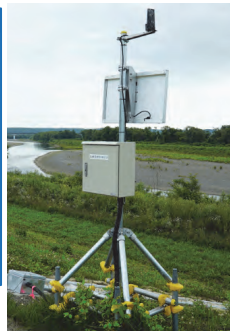
危機管理型水位計の設置によるきめ細かな河川水位の把握
