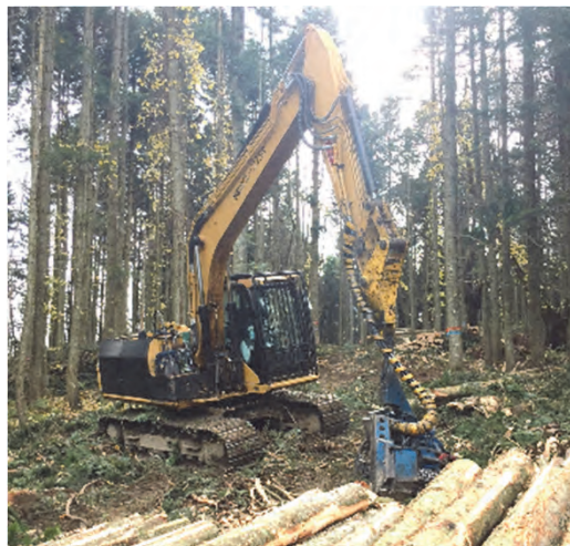
一台で立木の伐倒・枝払い・玉切り・集積が可能な高性能林業機械「ハーベスタ」
