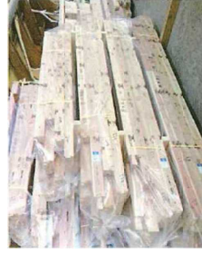
写真-2 プレカット工場で梱包された状態の例
