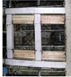
CLT耐力壁の例(袖壁タイプ) 国土技術政策総合研究所 「総合研究開発プロジェクト」資料より
