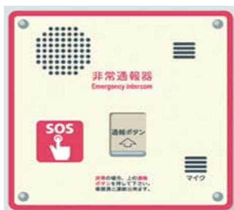
車内非常通報機
