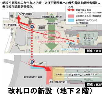
改札口の新設（地下2階）
