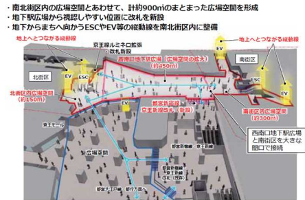
西南口地下駅広場につながる改札口の新設
