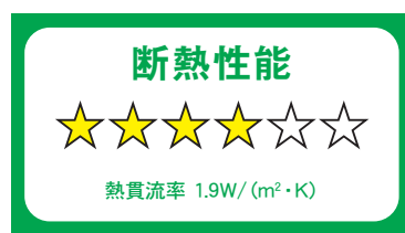
断熱性能4つ星の表示ラベル(熱貫流率1.9W/(㎡・K))
