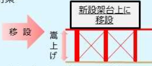
▲ 川崎変電所の高上げ工事 (浸水および高潮への対策)
