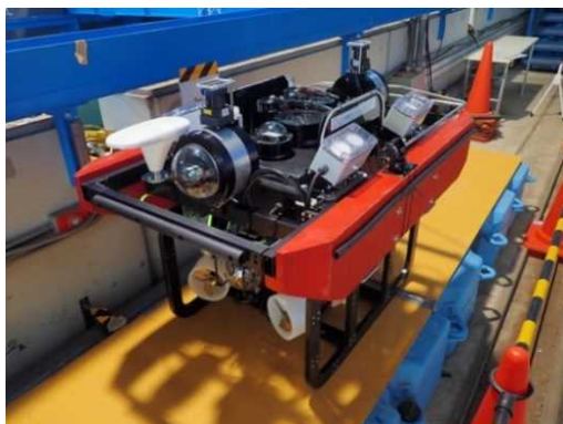
写真-1 栈橋上部工点検用ROV
