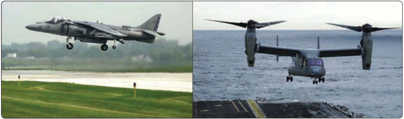
図 5-4. 一部の航空機には、推力の方向を変更する機能がある。
