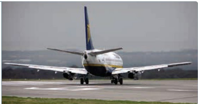
図 5-28. 上反角とは、Ryanair Boeing 737のグラフィック表示と背面図に示されているように、平面の水平（正面/背面）軸からの翼の上向きの角度である。
