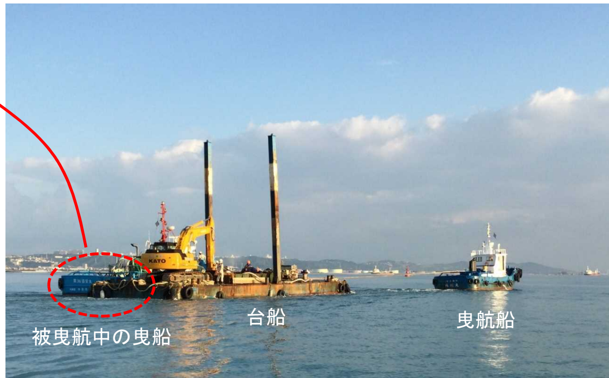
曳船2隻体制による曳航作業(被曳航中の曳船は台船に固縛)
